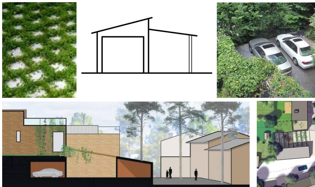
Kuvat 9-13. Nurmikiveä, yhden auton autotalli, jonka vieressä autokatos, istutuksilla erotetut autopaikat, autopaikkaratkaisu rinteeseen rakennetussa rivitalokortteleissa.
