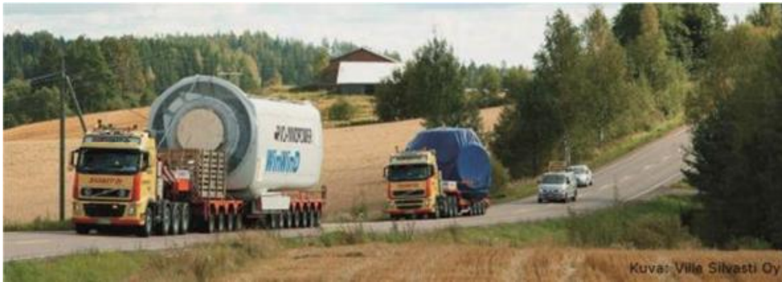
Transport av delar till vindkraftverk (maskinhus och nav)
