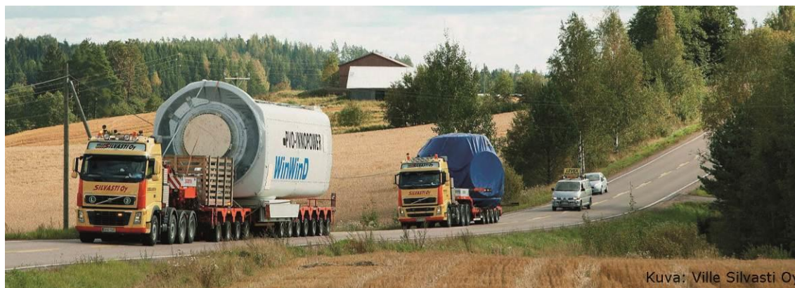
Figur 6-1. Transport av delar till vindkraftverk (maskinhus och nav)
