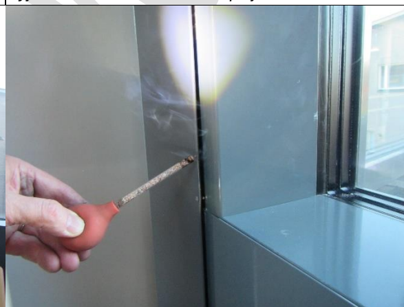
27. Ilmavuotoa sisätiloihin päin kulman listan takaa
