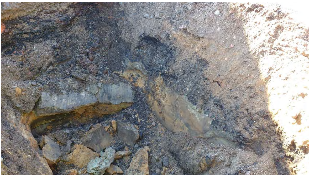
Kuva 4. Koekuopassa KK4 todettiin kuonakerros.
