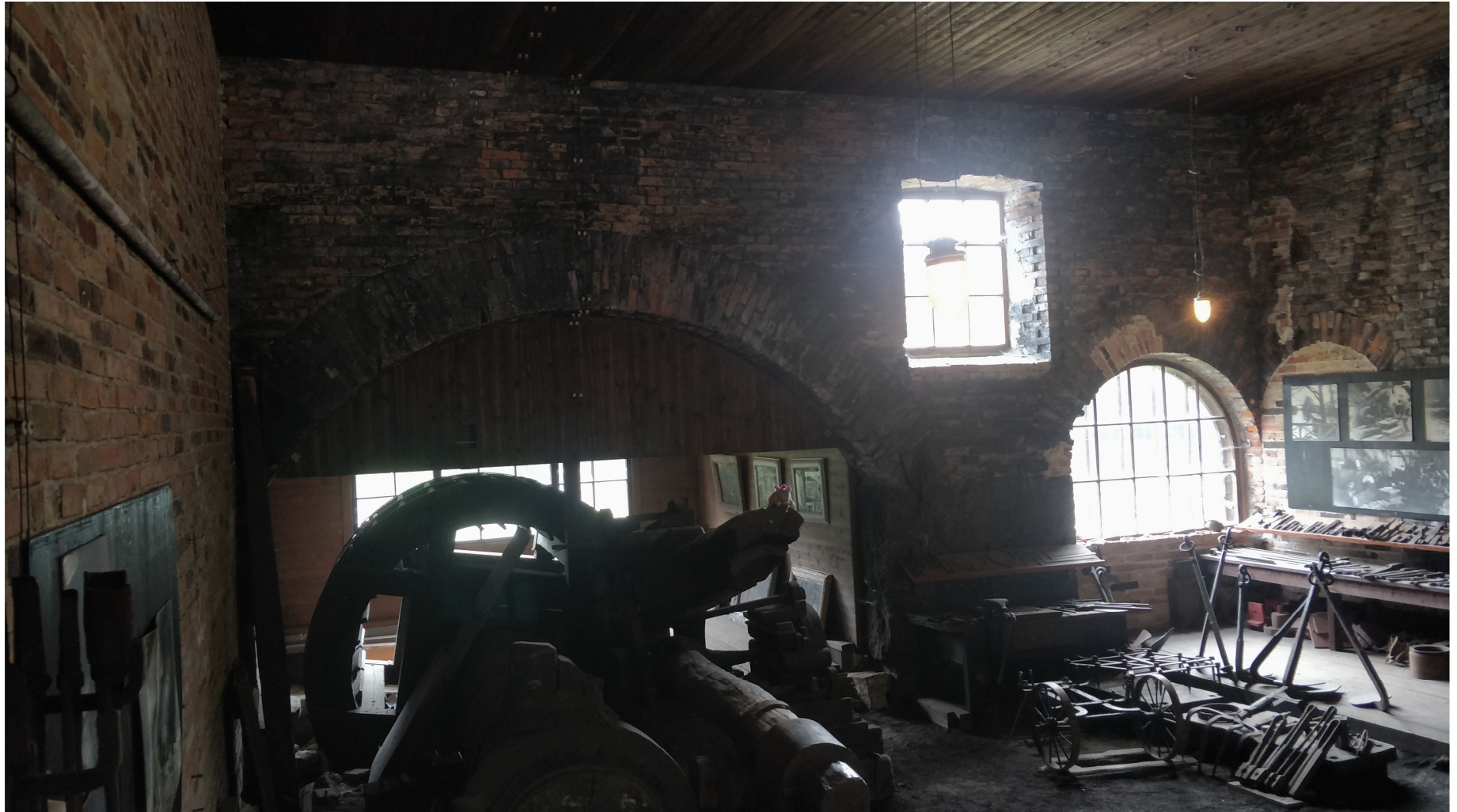
Kuva 69. Museotila koskelle päin kuvattuna. Vesipyörä ja vasara ovat alkuperäisillä paikoillaan, sen edessä on vasaran pienoismalli. Vesipyörähuone on uusittu 1990-luvun korjaustöissä. Oikealla on lautarakenteinen koroke ja hyllyt, jossa esitellään pajalla tehtyjä tuotteita. Tila on pitkälti samanlainen kuin museon aloittaessa 1960-luvulla. Oikealla kulmassa näkyy umpeen muurattu kulkuaukko, josta kuljettiin puhallinhuoneeseen.
