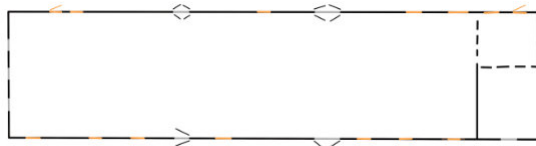
Kuva 19, Luonnos Navetan mahdollisesta alkuperäisestä tilajaosta palovakuutusasiakirjojen kuvauksen perusteella. Oranssilla vuoden 1945 mittauspiirroksen aukot, jotka eivät välttämättä ole alkuperäisillä paikoillaan.
