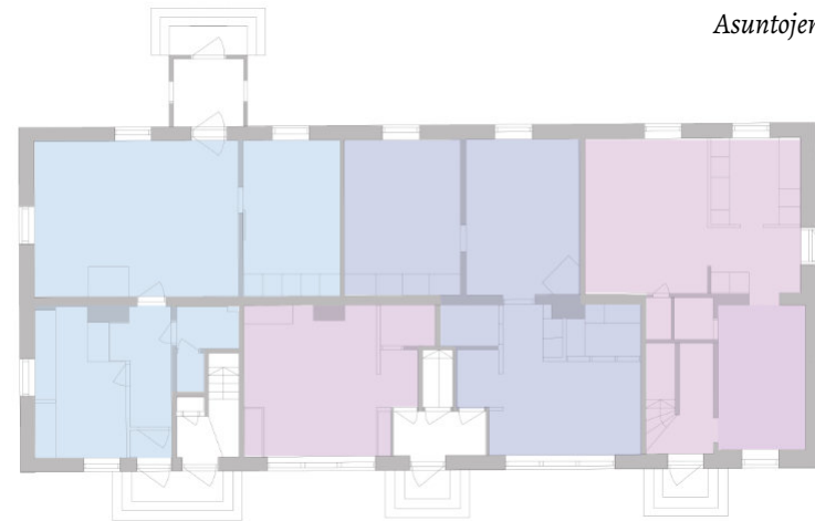
Kuva 59. Diagrammi ensimmäisen kerroksen huoneistokokonaisuuksien muutoksista. Hahmottamisen helpottamiseksi asunnoille on annettu eri sävyjä.
