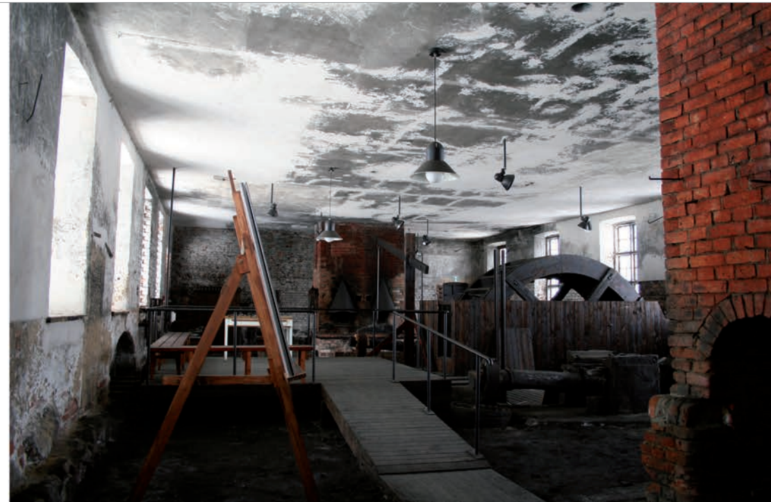
Vuonna 1996 kunnostetussa Yläpajassa (Härö Arkkitehti Oy) on vanhan mallin mukaan rakennettu uusi vesikäyttöinen kankivasara sekä valmistustekniikkaa kuvaava näyttely. Pajassa annetaan taontanäytöksiä lähinnä kesäisin
