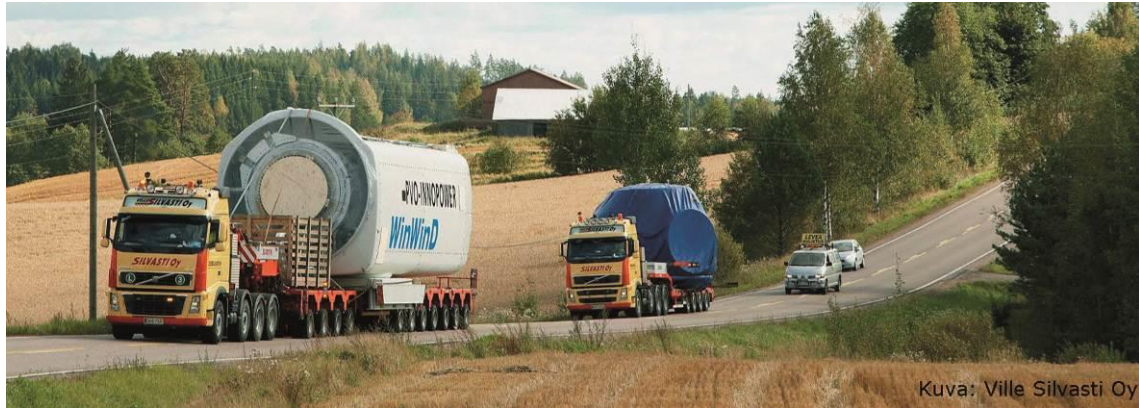
Figur 6-3. Transport av delar (maskinhus och nav) till vindkraftverk.
