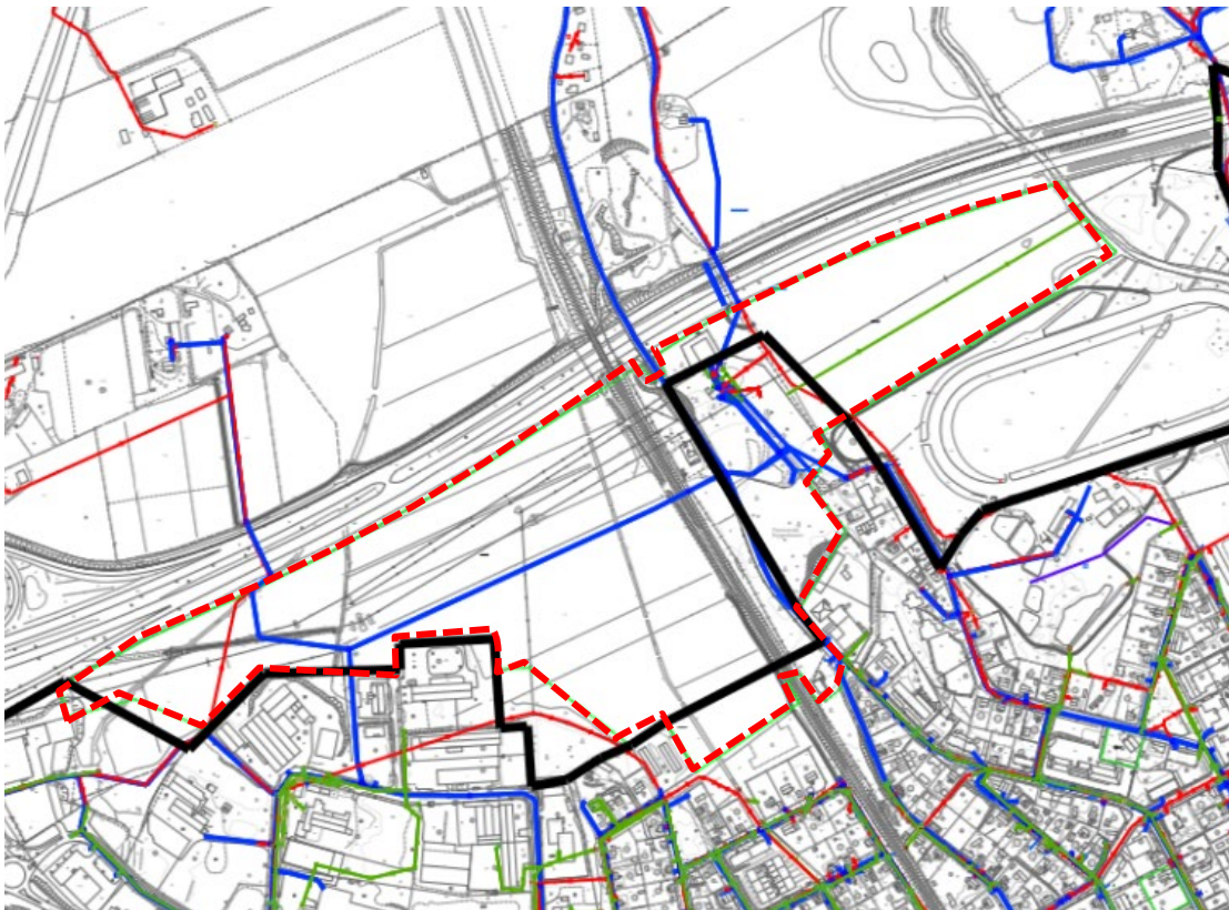
Karttaote maanalaisista putkista. Käyttövesi sininen, jätevesi punainen, hulevesiviemäri tumma vihreä. Vesilaitoksen toiminta-alueen raja musta.
