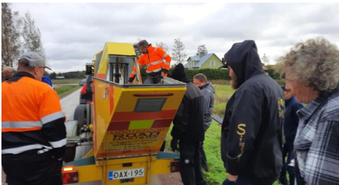
Bild 3. Arbetsdemonstration; mätning av vägens bärighet Välskötta vägar dagen i Liljendal 12.10.2023
