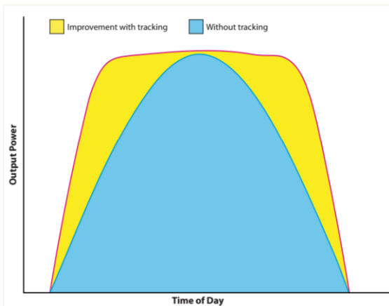
Kuva 2. Aurinkoseuraimella (tracking) varustetun aurinkopaneelin tuotanto esitetty keltaisella vuorokauden eri aikoina suhteessa kiinteäasenteiseen aurinkopaneeliin.
